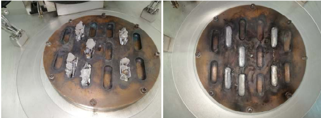
Materiale și mini-lingouri obținute din aliajul cu entropie ridicată FeMoTaTiZr.
