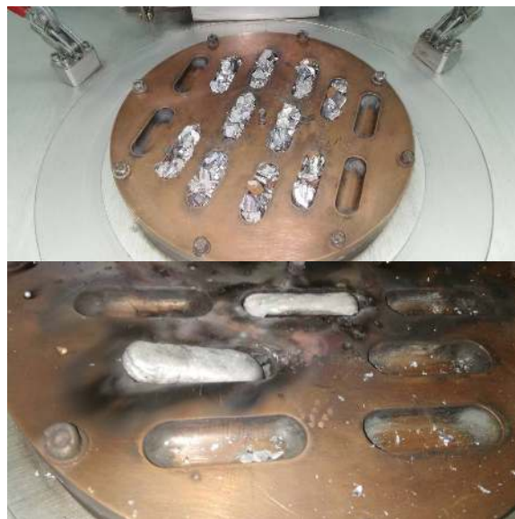
Probe din aliaj metalic biocompatibil multielement MoNbTaTiZr obținute prin topire în instalație RAV
