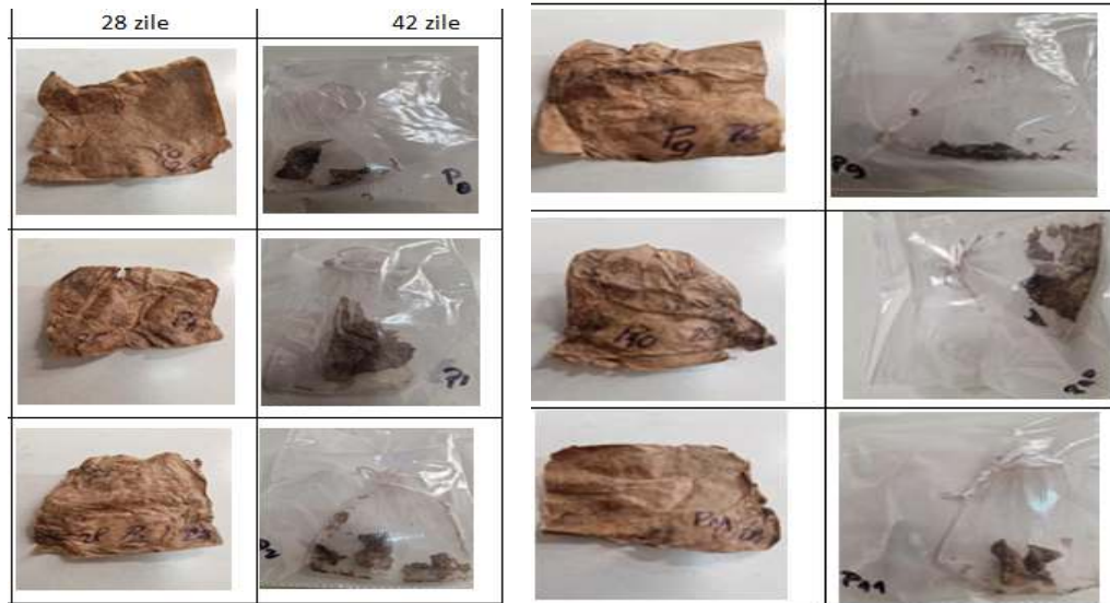
Imagini ale mostrelor de hârtie după degradarea în sol 28 și 42 de zile
