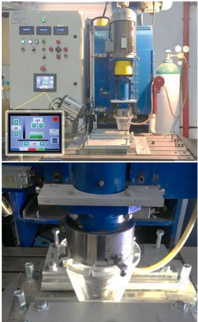
Echipamente de lucru sudare FSW-IG și detaliu incintă pentru aplicare gaz inert
