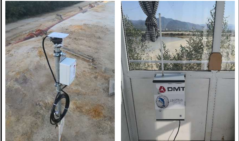
Fig. 2. Senzor piezometric (stânga) și data logger (dreapta) sit Baia Mare
